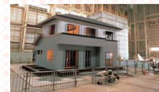
実物大振動実験で震度7をクリア
