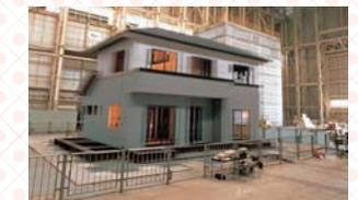
実物大振動実験で震度7をクリア
