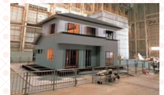
実物大振動実験で震度7をクリア 震度7相当の揺れを5回に渡って加える実物大振動実験をクリアし、高い構造強度を立証。
